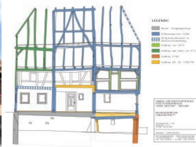
Baualtersplan, Längsschnitt Zu sehen ist der Zustand des Gebäudes vor Beginn der Sanierung 2003. Gut zu erkennen sind die beiden Firstständer in der Hausmitte und die vorkragende Erdgeschossdecke.
